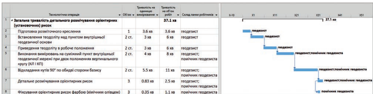
Рис. 4. Погодинний графік виконання робіт під час детального розмічування орієнтирних рисок із використанням теодоліту та металевої рулетки
